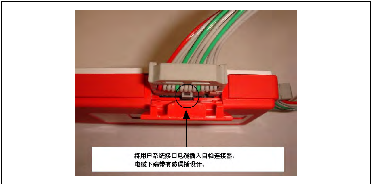
图 E.2 将用户系统接口电缆连接到自检连接器
