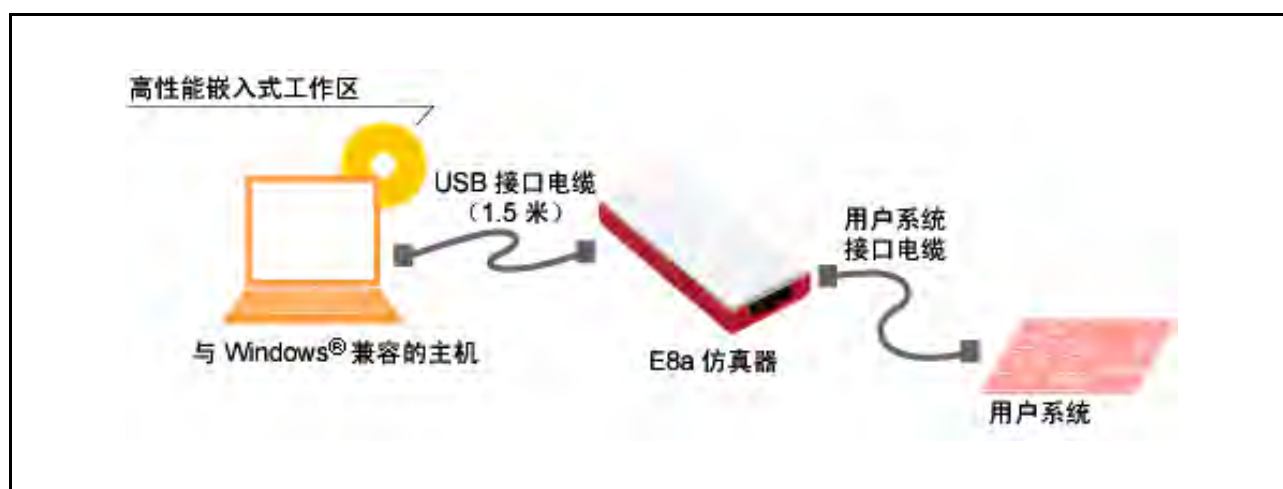
图 1.1 使用仿真器的系统配置
