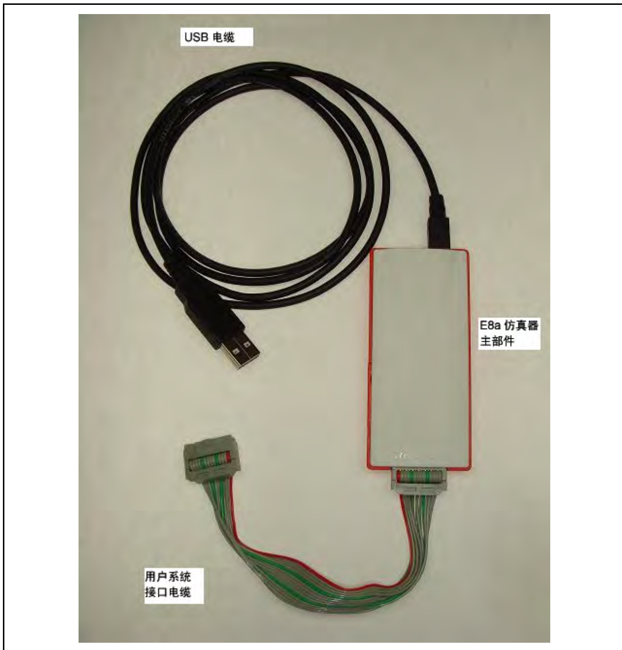
图 3.2 仿真器硬件配置
