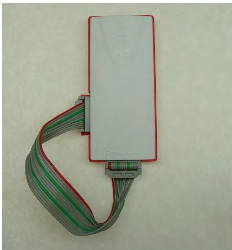
图 E.1 在使用 E8aSCP 时连接用户系统接口电缆
