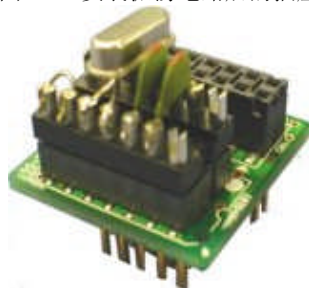
图 4-28 安装振荡电路后的插座
