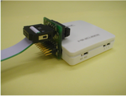
图 4-23 使用 10-Pin 连接头
