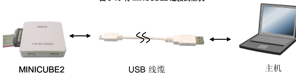
图 5-19 将 MINICUBE2 连接到主机
