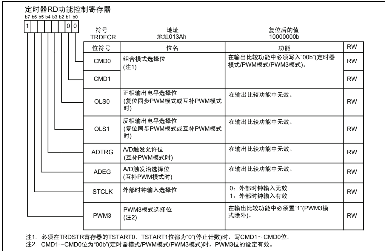
图 15.87 输出比较功能时 TRDFCR 寄存器
