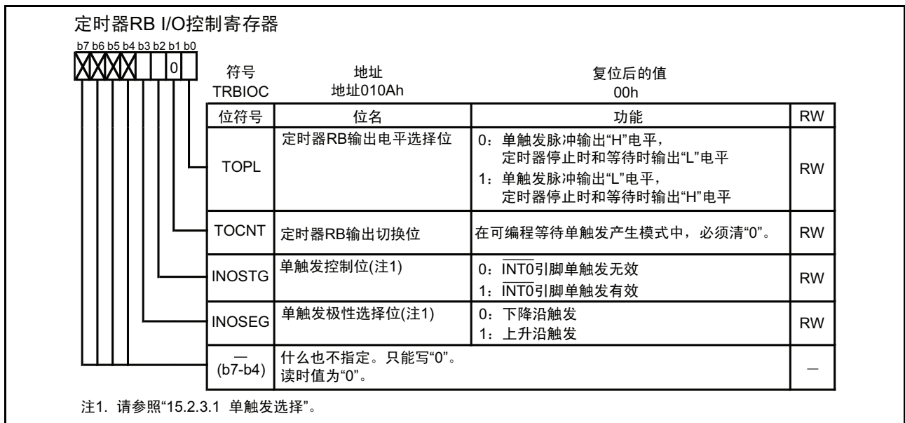
图 15.22 可编程等待单触发生模式时的 TRBIOC 寄存器
